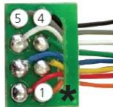
Abbildung 1: LokPilot 5 & LokPilot 5 micro mit 8-poliger NEM652 Schnittstelle
